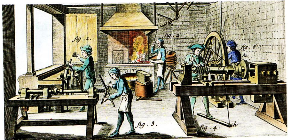
Doc. 3 Une planche de l'Encyclopédie : la taillanderie ou la fabrique d'outils en métal. Aux dix-sept volumes de texte viennent s'ajouter onze volumes de planches gravées décrivant les savoirs et les techniques.
