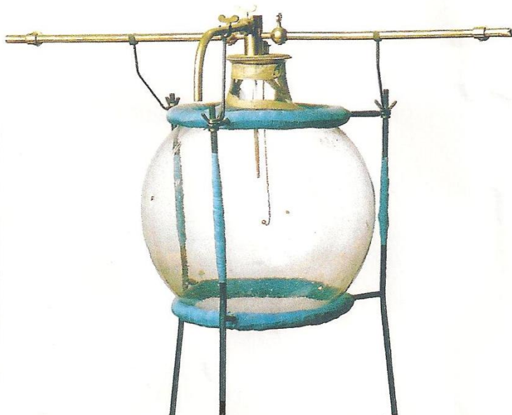
▲ Doc. 1 : Cet appareil, inventé par Lavoisier, lui a permis d'étudier la composition de l'eau.
