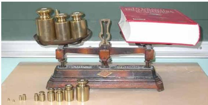
La **balance de Roberval** est une balance qui sert à mesurer des masses. Lorsque les 2 plateaux sont en **équilibre**, cela signifie que les 2 objets ont **la même masse**. La masse de l'objet est **égale** à la **somme** des masses placées sur l'autre plateau.
