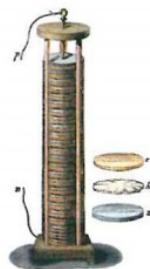
En 1800, le physicien italien Alessandro Volta fabrique la première « pile » électrique en empilant alternativement des disques de zinc, de cuivre et de carton imbibé de solution salée.
