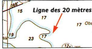
Les sondes de même profondeur peuvent être reliées par des isobathes (ou ligne de niveau bathymétriques).
