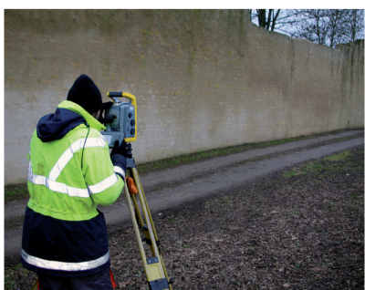
Relevé au théodolite de l'enceinte médiévale par un topographe
