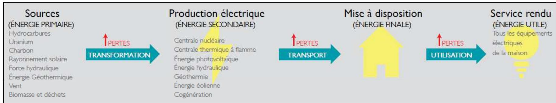
Entre l'énergie primaire et l'énergie utile, il y a **en moyenne 62 % de pertes**
