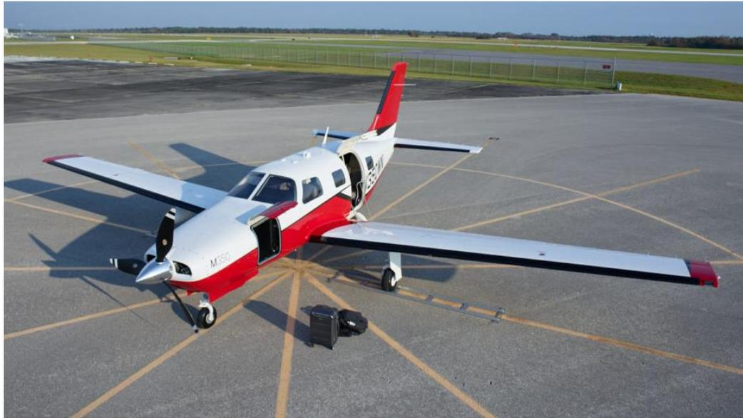
Le Piper PA46 est un avion monomoteur 6 places pressurisé
