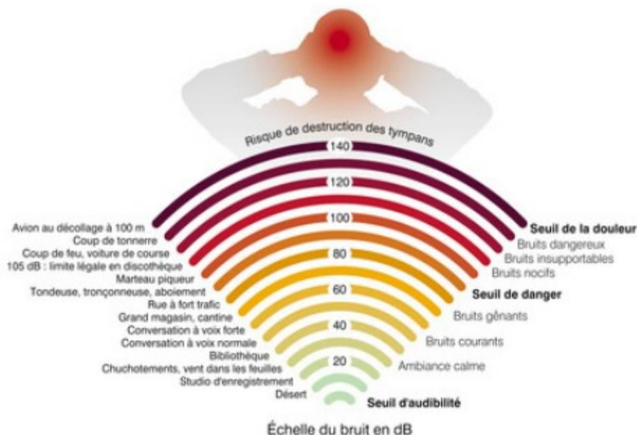
La plupart du temps, les parcs photovoltaïques installés dans des environnements champêtres produisent suivant le type d'onduleur (et éventuellement de transformateur) un bruit à quelques dizaines de mètres de 60 à 70db (exemple d'un onduleur nouvelle génération Ingeteam Dual Ingecon Sun Power) constituant ainsi une gêne réelle qui dans un contexte de silence peut à la longue présenter un risque de fatigue pour un voisinage proche.
