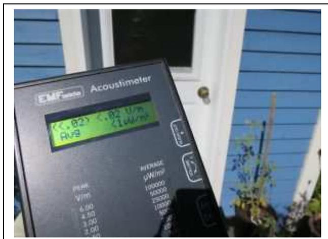
Les ondes mesuraient 0,02 V/m sur notre perron, sur le mur ouest, et 4,39 V/m sur le mur est, à 10 pieds de l'antenne Internet placée sur un arbre.
