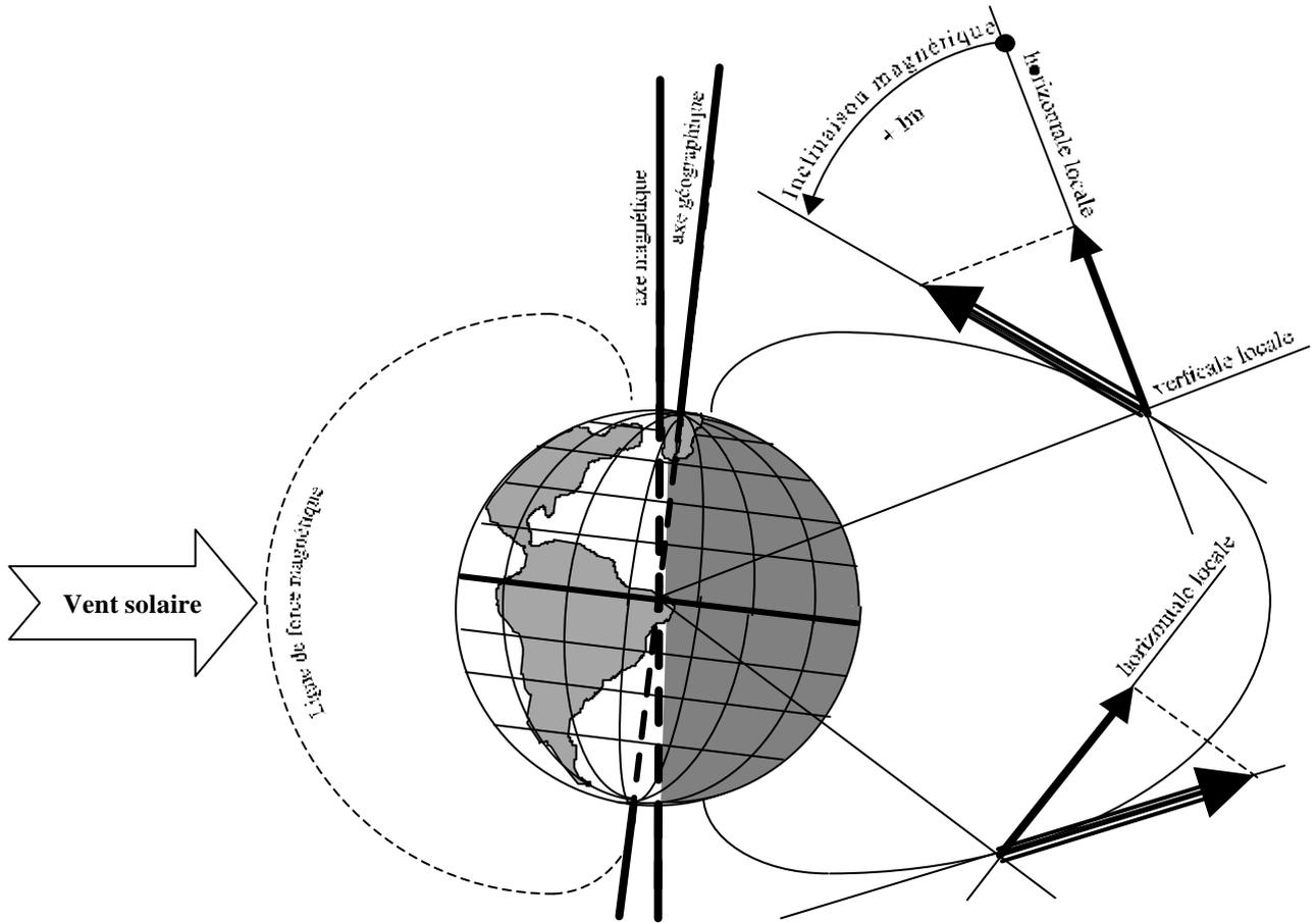
Le champ magnétique terrestre présente un spectre formé de lignes de forces orientées selon un axe différent de l'axe de rotation et appelé axe \_\_\_\_\_. En un point de la surface terrestre, l'aiguille d'une boussole s'aligne suivant la même orientation.
