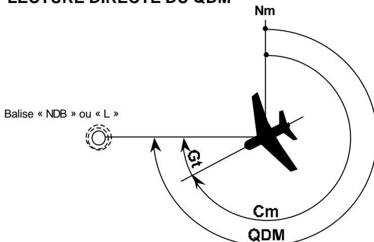
A l'aide du bouton de recalage, on fait tourner la rose de façon à afficher le cap magnétique en face de l'index fixe. L'aiguille indique alors le QDM.
