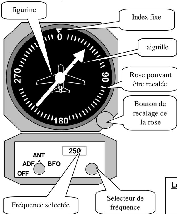
Le radio-compass mesure le \_\_\_\_\_ entre la ligne de foie de l'avion et la direction d'une radio-balise.
