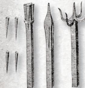
Les piques qui les composent sont d'abord étirées une à une dans un fer de faible section avant d'être ligaturées sur un fer plus fort puis soudées à chaude portée sur celui-ci.
