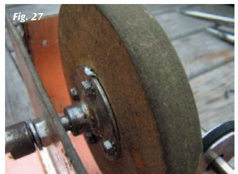
Lors des essais du rouleau de pression et du disque de friction, il y avait un peu de jeu sur le disque de friction. Stijn, ON3AU a trouvé la solution: il faut monter le disque de friction de façon libre sur son support, et mettre une petite cale (par exemple une rondelle) juste au bon endroit et puis il faut à nouveau tout resserrer (**figures 25, 26 et 27**). Le résultat est une rotation sans jeu.
