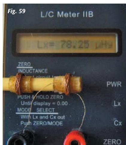
**Fig. 59 L/C Meter IIB**
