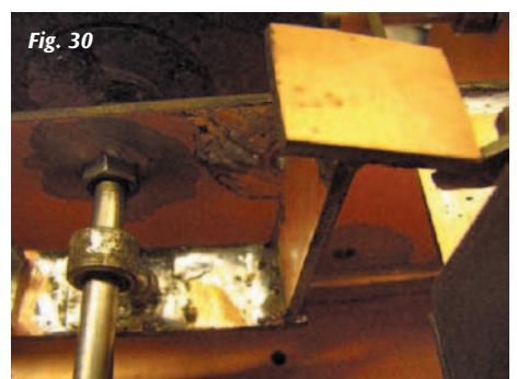
L'autre côté de la plaquette s'adapte dans un reste de profil en "U" en aluminium et perforé à 6 mm, qui à son tour, repose sur l'axe du dévidoir. Tout ceci apparaît plus clairement sur les **figures 30 à 33**.
