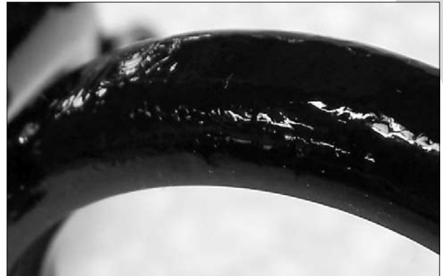
Fig. 7: Etat du revêtement après les tests aux chocs et impacts.
