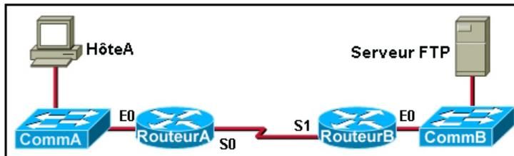
Lisez l'exposé. Un administrateur réseau sur l'hôte A rencontre des problèmes d'accès au serveur FTP. Le test de connectivité de la couche 3 est concluant de l'hôte A vers l'interface S1 du routeur B. Quel série de commandes permettrait à l'administrateur réseau d'accéder au routeur B par Telnet et d'y exécuter des commandes debug ?
