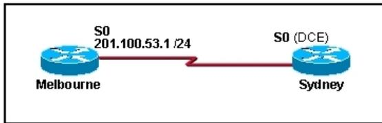
La connexion série représentée dans le schéma doit être configurée. Quelles commandes de configuration doivent être exécutées sur le routeur Sydney afin d'établir la connectivité avec le site de Melbourne ? (Choisissez trois réponses.)
