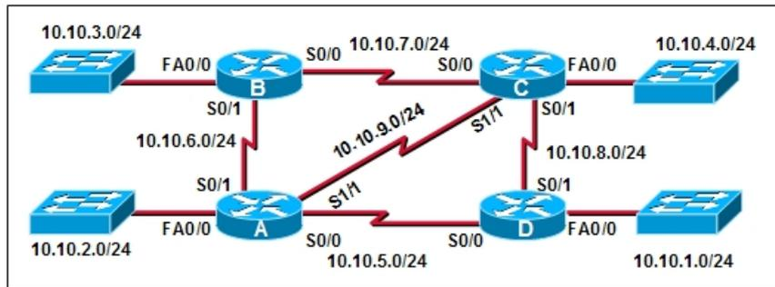
La connexion entre les routeurs B et C a été testée et fonctionne. Cependant, après le réamorçage du routeur C, l'administrateur remarque que les temps de réponse entre les réseaux 10.10.3.0 et 10.10.4.0 sont plus longs. La commande ping entre les deux routeurs indique que la connexion est bonne. La commande traceroute fait état de trois sauts du routeur B vers le routeur C. Que peut-on encore essayer pour tenter de résoudre le problème ?
