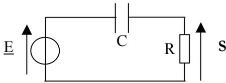
1°/ Exprimer la fonction de transfert  $\underline{T} = \underline{S}/\underline{E}$  du circuit en fonction de R, C et  $\omega$ . Mettre cette fonction de transfert sous la forme :
