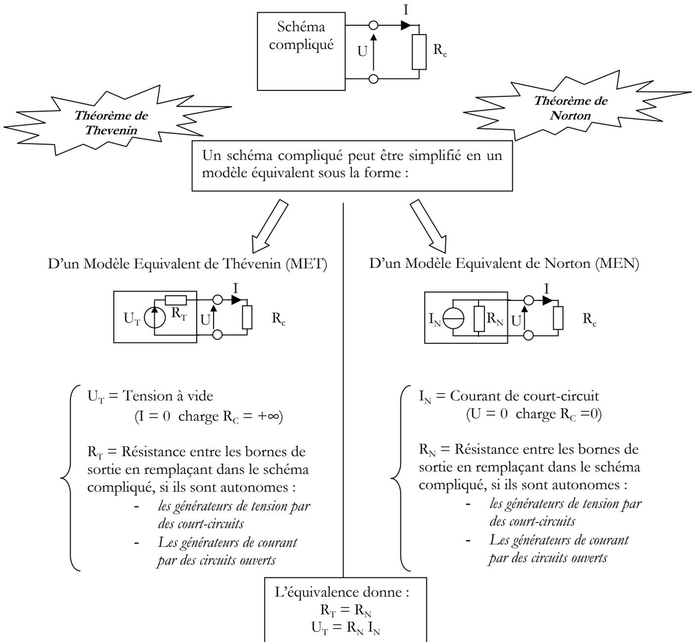
Définition d'un générateur autonome : C'est un générateur qui délivre une grandeur électrique (courant ou tension) non commandée par une autre.
