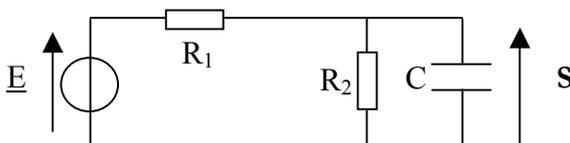
1°/ Exprimer la fonction de transfert  $\underline{T} = \underline{S}/\underline{E}$  du circuit en fonction de  $R_1$ ,  $R_2$ , C et  $\omega$ . Mettre cette fonction de transfert sous la forme :
