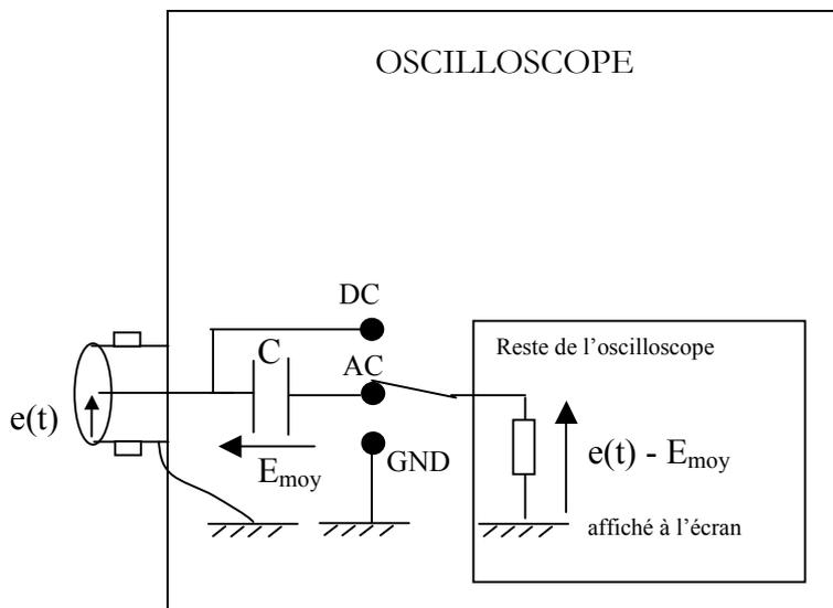
Avec le couplage AC, un condensateur de forte capacité (ainsi  $\tau \gg \gg \gg T$ ) bloque la composante continue du signal appliqué sur l'entrée.
