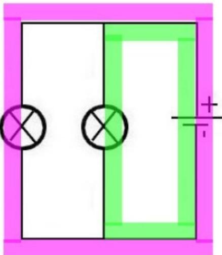
b. Si on court-circuite une des lampes, toutes les lampes s'éteignent, et le courant ira directement du + au -, en passant par le fil de court-circuit.
