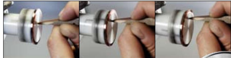
Satinage «circulaire» effectué à l'aide d'une baguette en bois recouverte de papier d'émeri
