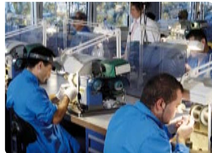
Les mains des polisseurs sont mises à forte contribution, notamment lors d'opérations réalisées sur des pièces particulièrement dures (platine) ou lorsqu'ils manipulent des pièces de petite taille. C'est pourquoi ils portent souvent des gants en coton ou recouvrent leurs doigts de protections en cuir ou en caoutchouc.
