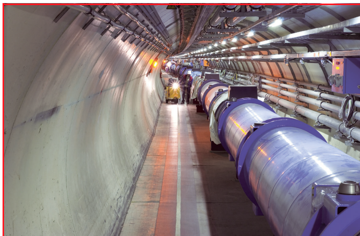
Figure 6 - Le LHC est un anneau de 27 km de circonférence, situé à 100 m sous terre. © CERN.
