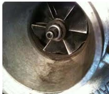
**Ce brouillard d'huile entraine souvent un arrachement de matière par cavitation sur les aubes du compresseur !**
