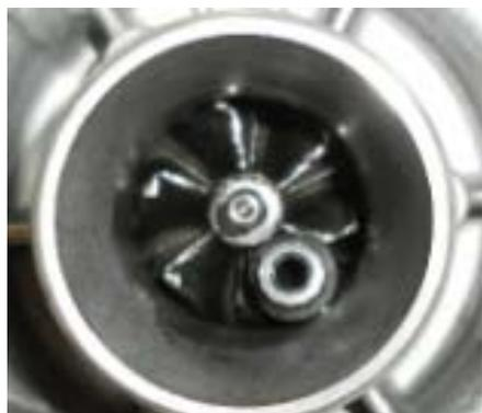
Le grippage du turbocompresseur provient d'un manque de lubrification ou de la rupture du film d'huile entre l'axe et le palier, les causes les plus fréquemment retenues sont :
