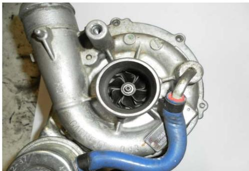
La cavitation se traduit par un **arrachement** de matière sur l'extrémité des aubes de la roue compresseur. Les causes de ce phénomène sont :
