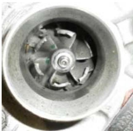
La survitesse a pour conséquence la destruction de l'ensemble tournant dans sa quasi-totalité. Ce phénomène est engendré par un mauvais pilotage de la régulation du turbocompresseur, les fautifs sont :
