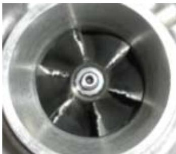
La destruction du turbocompresseur par des corps étrangers se traduit par les points suivants :
