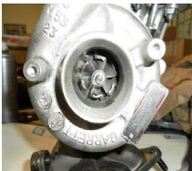
Le pompage a pour effet de détruire principalement la partie compresseur. Il provient d'une différence anormale entre l'entrée et la sortie du carter compresseur, les raisons les plus fréquentes sont :
