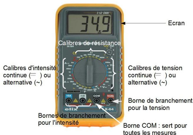
Un calibre correspond à la plus grande valeur que l'appareil peut mesurer. Par exemple sur 20V, l'appareil ne peut mesurer des tensions que jusqu'à 20V, au-delà un signal d'erreur apparaît.
