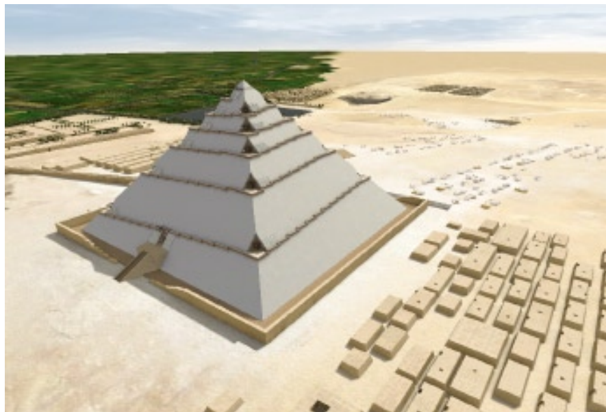
20ème année du règne, vue sous un autre angle. Le chantier principal est terminé, le pyramidion est en place au sommet ; les travaux de parachèvement vont commencer depuis le sommet.
