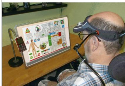
Pointeur laser de communication « Kozette » monté sur visière
