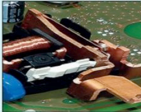
Le disjoncteur intégré au compteur Linky
