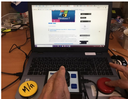
X-Mouse Button Control : défilement obtenu par déplacement d'un joystick + appui sur un contacteur correspondant au clic droit
