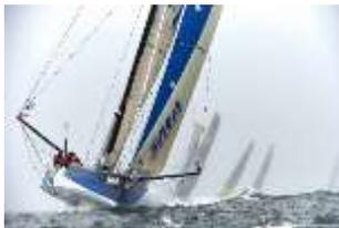
2. Les **Imocas** : Ce sont des bateaux monocoques de 18 m, conçus pour être manœuvrés en solitaire. Ils ont aussi des foils, qui améliorent leur vitesse, car ils leur permettent de s'élever au-dessus de l'eau, à grande vitesse.
