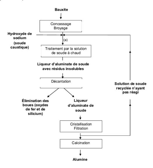
Après broyage, la bauxite est attaquée à chaud, sous pression, par une solution de soude, ce qui permet d'obtenir une liqueur d'aluminate de soude avec des résidus insolubles en suspension. Cette liqueur est ensuite décantée : les oxydes de fer et de silicium forment une boue rouge, chimiquement inerte, qui est évacuée vers un site de déversement approprié.
