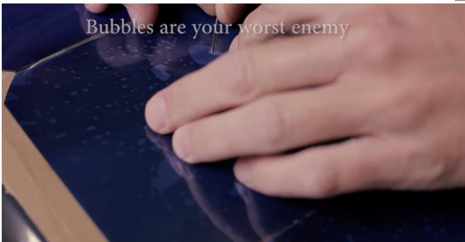
Les bulles d'air causent une grande perte en rendement (augmente la résistance des CPV) donc il faut les éviter. ( les grands fabricants des panneaux solaires utilisent des techniques sous vide)
