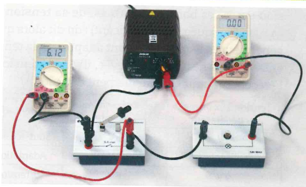
Fig. 1 : Mesures de la tension aux bornes d'un interrupteur ouvert et de l'intensité du courant dans le circuit.
