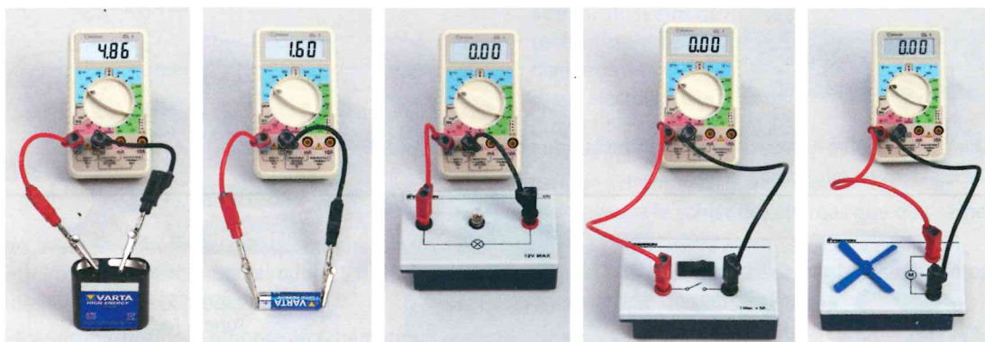
Fig. 1 : Mesures des tensions aux bornes de dipôles isolés.
