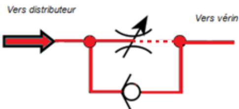
Le clapet s'ouvre, l'air circule normalement dans le RDU
