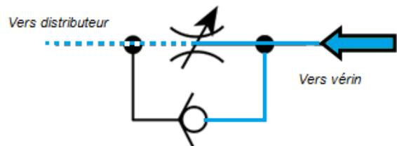
Le clapet ne s'ouvre pas, le débit d'air est réduit par le réducteur de débit réglable. La vitesse de la tige du vérin est réduite.
