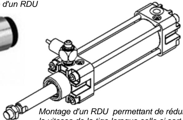
Montage d'un RDU permettant de réduire la vitesse de la tige lorsque celle ci sort.
