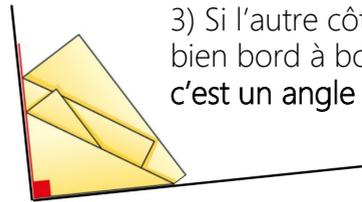
3) Si l'autre côté de l'angle est bien bord à bord du gabarit, c'est un angle droit.
