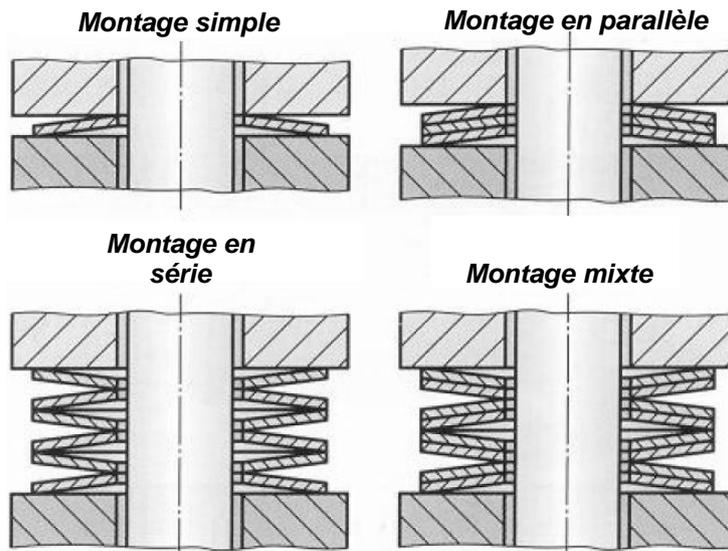
**Q1c : Expliquer** la procédure à suivre (sans modifier le type de montage des rondelles belleville) afin d'augmenter le couple transmissible entre le disque repère 54 et l'arbre repère 48.
