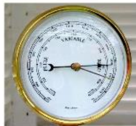
Baromètre : appareil de mesure de pression atmosphérique
