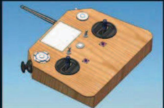
Avec ses 7 entrées analogiques et son architecture modulaire, NextStepRC peut répondre à des besoins exotiques, comme ici une radio dotée d'un mini-manche additionnel pour le FPV (vol en immersion). Rien n'empêche non plus d'intégrer à la radio un écran de retour caméra : tout ou presque est imaginable.
