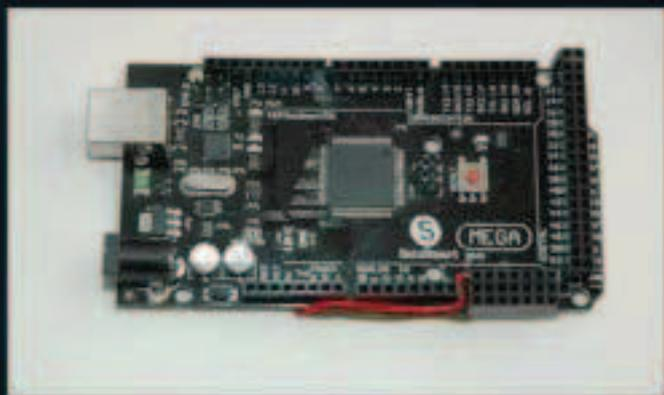
On distingue en bas et en haut à droite les connecteurs additionnels (simplement collés à la cyano) pour faciliter respectivement le câblage des manches et de l'écran.
