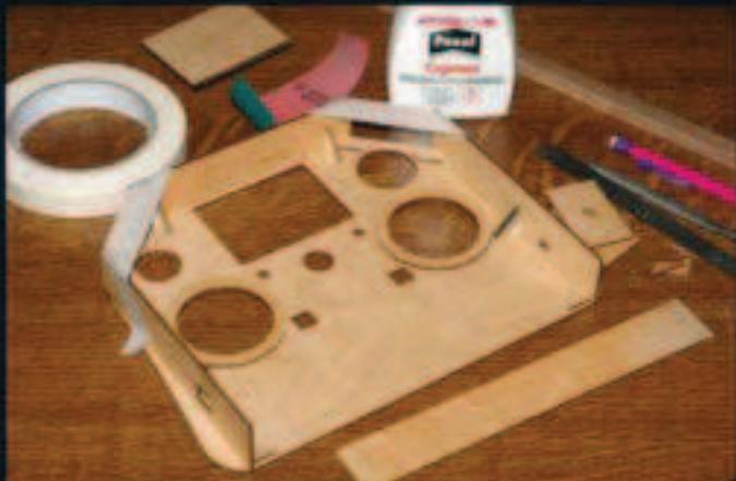
Les collages se font à la colle blanche rapide, avec l'aide de Scotch papier pour maintenir les éléments. L'acquerrage doit être soigné et, à cet effet, les pièces non encore collées peuvent être mis à contribution.
