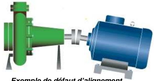
Exemple de défaut d'alignement entre un moteur et une pompe
