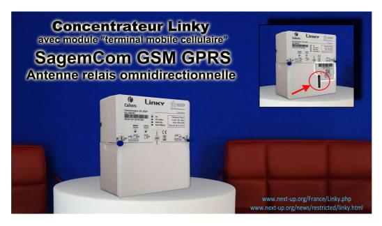
En ce qui concerne l'antenne RELAIS GPRS elle est incorporée (elle pend sous le module), néanmoins lorsque la BST est éloignée, en zone non urbaine, <u>il y a une antenne extérieure</u> plus performante!
