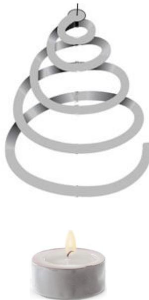
2/ Un dispositif genre hélice disposée au-dessus d'une source chaude permet de mettre en évidence la convection, cette montée d'air chaud. On pourra utiliser une spirale en papier tournant autour d'un axe vertical.
