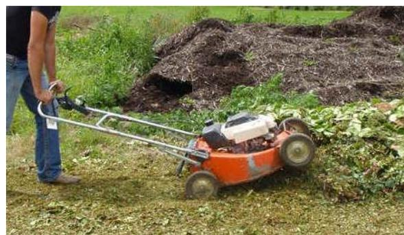
**La tondeuse :** peut être utilisée pour broyer du branchage de diamètre inférieur à 1,5 cm.
