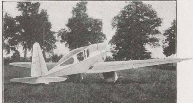
Deux aspects du monoplan biplace POITE III, à conduite intérieure (moteur RENAULT 100 HP).
