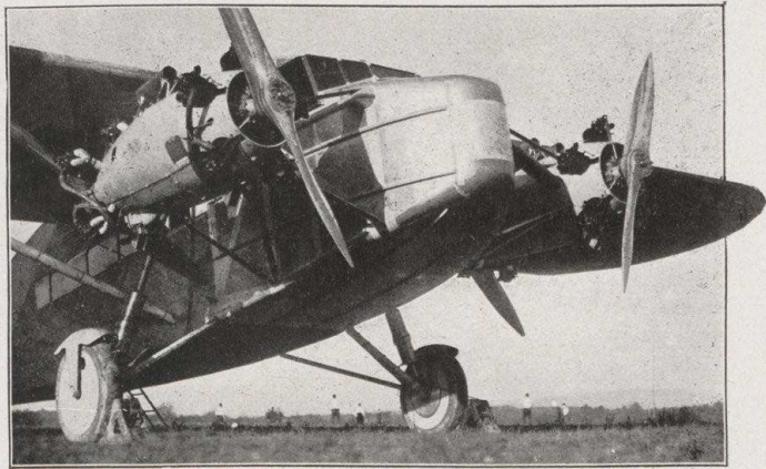
A gauche et en haut, le Do. K, monomoteur. en vol; en bas, le même appareil transformé en quadrimoteur. A droite, détail des groupes. Sur le Do. K, les deux tandems, placés de part et d'autre de l'avant du fuselage, sont supportés par ce dernier au moyen d'un système de contre-fiches; les moteurs sont ainsi très en avant du bord d'attaque de l'aile. Cet appareil est purement expérimental; l'étude de sa formule se poursuit et les documents ci-dessus, pris en cours d'évolution, ne correspondent peut-être déjà plus à la forme actuelle.
