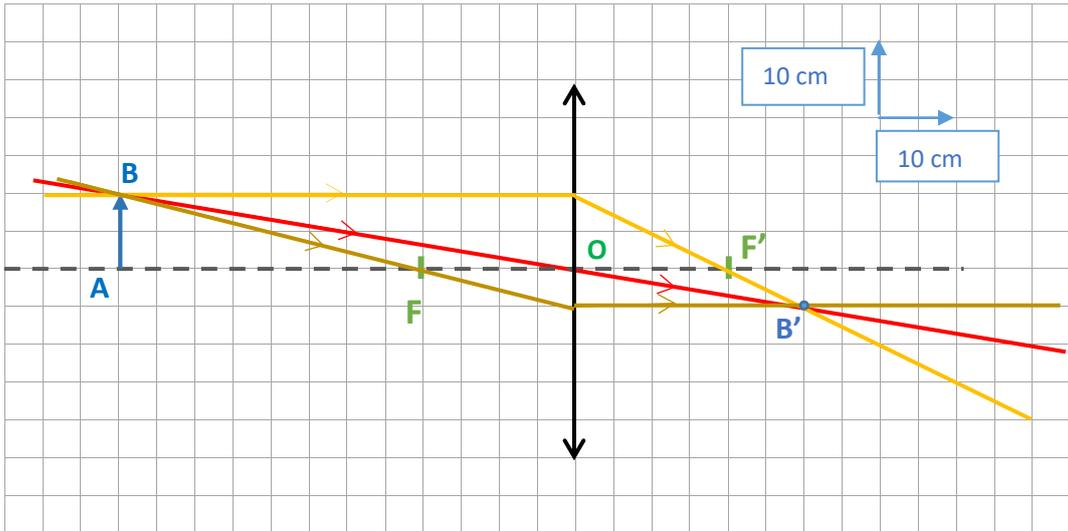
Une fois le point B' placé, on placera A' sur l'axe optique de manière à ce que l'image, comme l'objet, soit perpendiculaire à l'axe optique.
