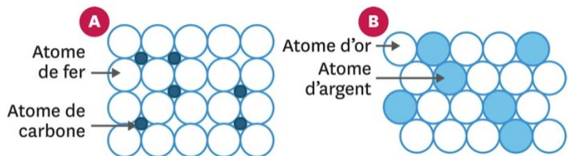
A. Alliage formé par insertion. Exemple de l'acier: les petits atomes de carbone (1 % de l'alliage) sont insérés entre ceux du fer, plus gros (99 %).
