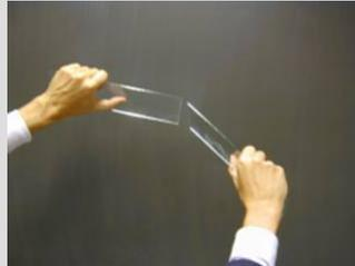
Le verre a une très longue phase élastique caractérisée par un **module d'élasticité** d'environ  $E = 70'000 \text{ N/mm}^2$  (environ 1/3 de celui de l'acier). La limite de la phase élastique correspond à la rupture du matériau (résistance du matériau  $f_t$ ) Elle intervient sans que le matériau ait subi précédemment de déformations plastiques (irréversibles). Ce comportement est défini comme **fragile**.
