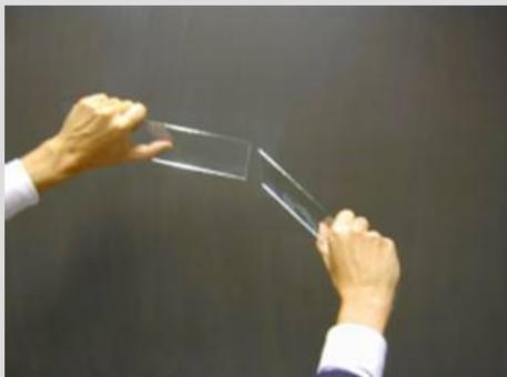
D'autres matériaux ont un comportement complètement différent. C'est par exemple le cas du verre: une fois atteinte la limite du domaine élastique, une fissure se propage soudainement à travers l'élément et provoque la rupture. Dans ce cas le comportement est **fragile**.
