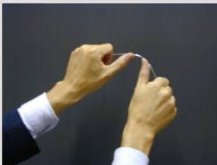
Si nous plions un fil de fer et dépassons une certaine limite, nous provoquerons alors une déformation irréversible. Mais il ne s'agit pas encore de la rupture du matériau ; pour atteindre l'arrachement de l'acier nous devons provoquer de très grandes déformations unitaires. C'est ce qu'on appelle **comportement ductile**.
