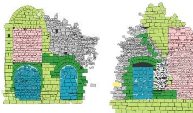
Figure 52 : Interprétation des maçonneries des deux faces du mur gouttereau Est de la Grande salle. À gauche, la face Ouest, à droite la face Est.
