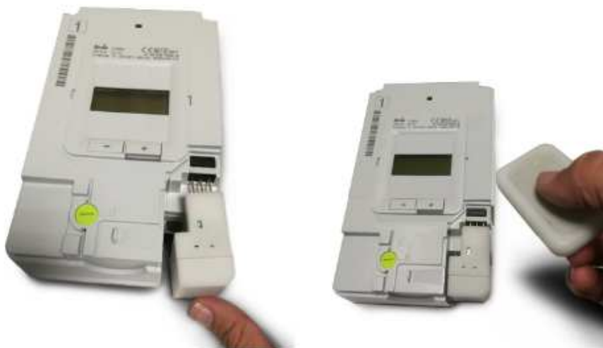
Branchement du module radio ERL sur Linky et utilisation de la télécommande ERL.
