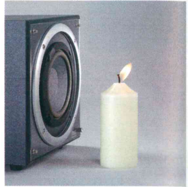
La vibration de la membrane du haut-parleur provoque un déplacement d'air qui fait vaciller la flamme de la bougie.
