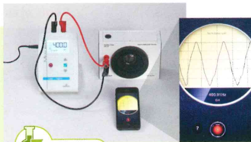
Fig. 1 : Mesure de la fréquence du son.
