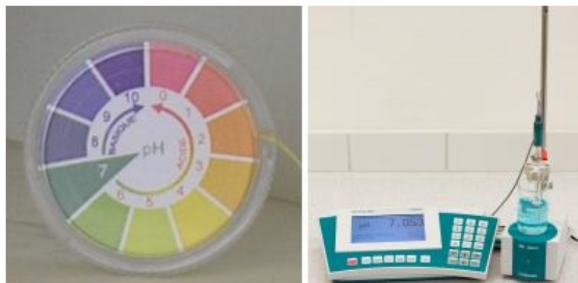
À gauche, un rouleau de papier pH avec son code de couleurs. À droite, un pH-mètre mesure le pH de la solution bleue.
