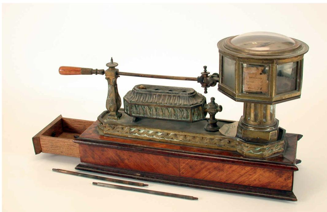
Pyromètre à cadran dit d'Arsандаux, permettant la mesure de la dilatation des solides en fonction du matériau, de leur longueur et de la température. ASEISTE
